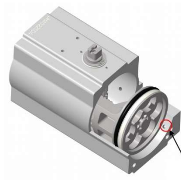
Auslassöffnung gut sichtbar
